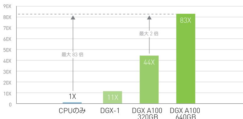
ビッグデータ分析ベンチマーク | 10 TB データセットで分析リテールクエリ 30 個, ETL, ML, NLP | CPU: Intel Xeon Gold 6252 2.10 GHz の 19 倍, Hadoop | DGX-1 (V100 32 GB の 8 倍) の 16 倍, RAPIDS/Dask | DGX A100 320 GB の 12 倍および DGX A100 640 GB の 6 倍, RAPIDS/Dask/BlazingSQL GPU の台数に標準化した速度向上率
